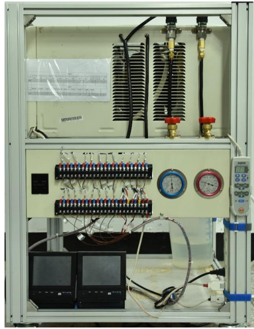
圖 11 窗型空調機儀表安裝位置照片
