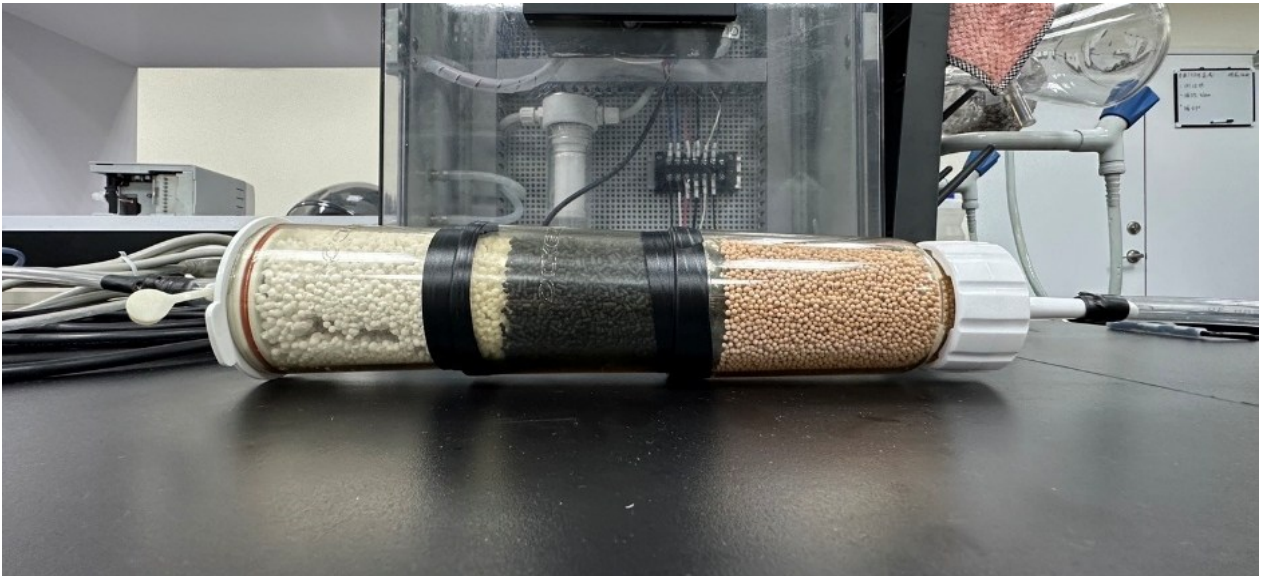
圖 4、自製氣體純化裝置(左至右：無水氯化鈣、活性炭、分子篩)。
